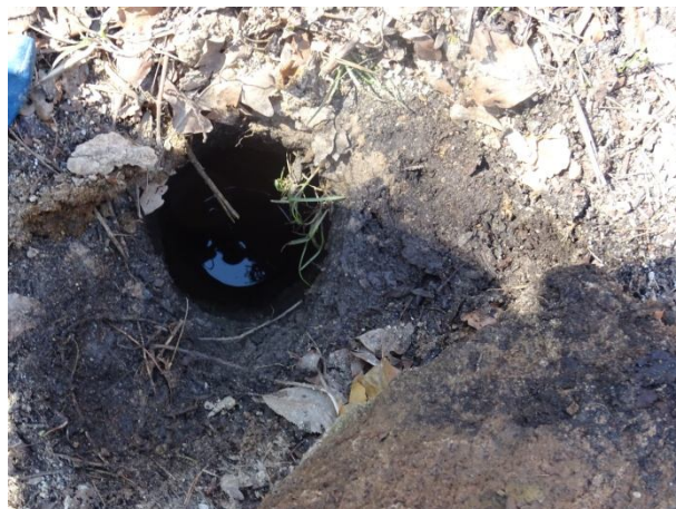
Моторен сондаж при банкета на пътя
