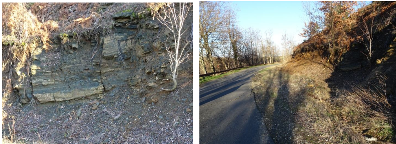
Разкритие на изветрели и напукани скали
