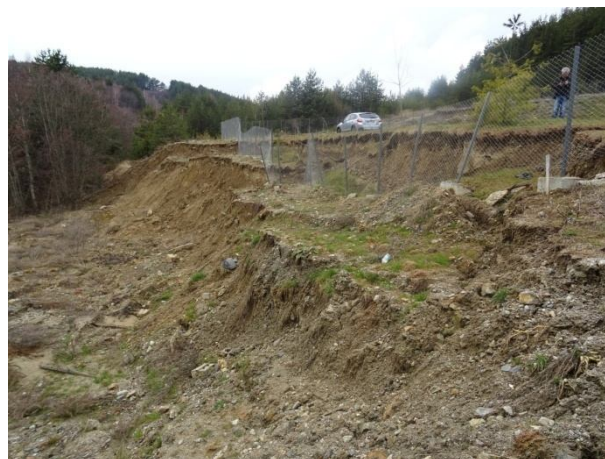
Нововъзникнал свлачищен участък с ясно изразен главен свлачищен откос
